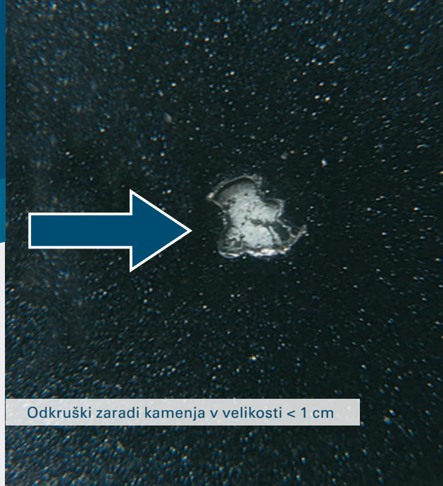
Majhna praska v velikosti < 1 cm, jo je mogoče odstraniti s poliranjem
